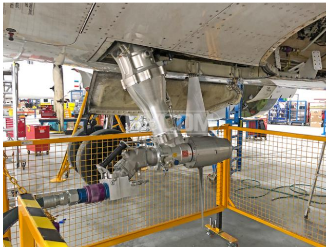
Figura 22 – Sistema de teste de um trem de aterragem [40]
