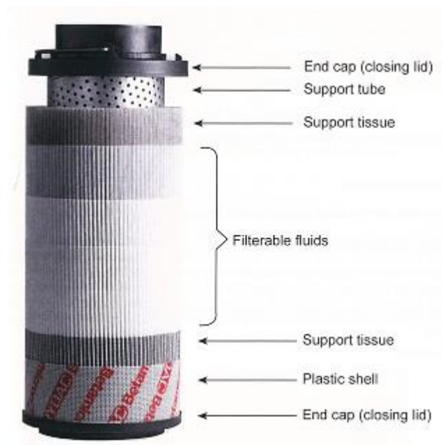
Figura 62 – Composição do elemento filtrante [3]
