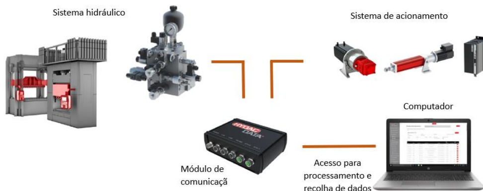
Figura 82 – Esquema de comunicação de recolha e tratamento de dados [3]
