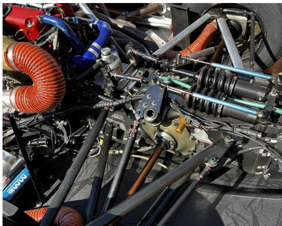
FIGURA 2.23: Suspensão traseira do Ligier JS49/51 EVO . 17
