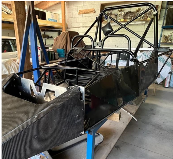
FIGURA 2.11: Placas anti-intrusão pertencentes ao modelo ADR3 . 10
