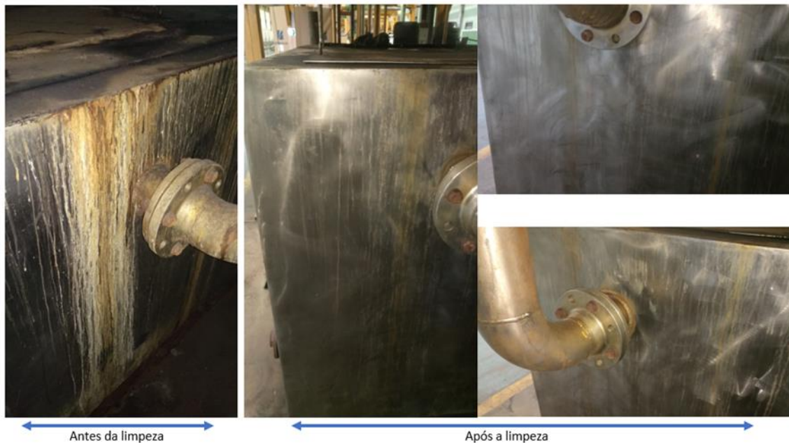
Figura 28 - Exemplo 3 de zona de ensaio da limpeza com recurso ao gelo seco
