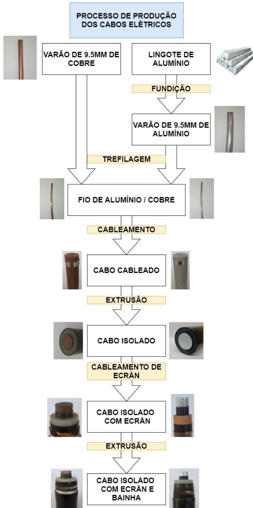
Figura 14 - Processo de produção dos cabos elétricos na Soidal
