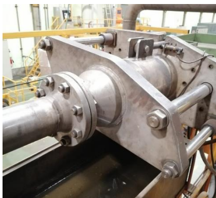
Figura 44 - Sistema de vedação ( endsealing ) existente na empresa
