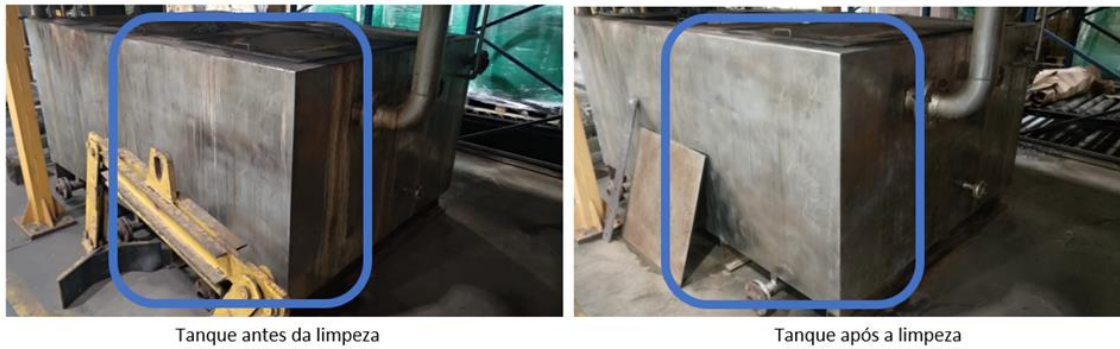
Figura 27 - Exemplo 2 de zona de ensaio da limpeza com recurso ao gelo seco
