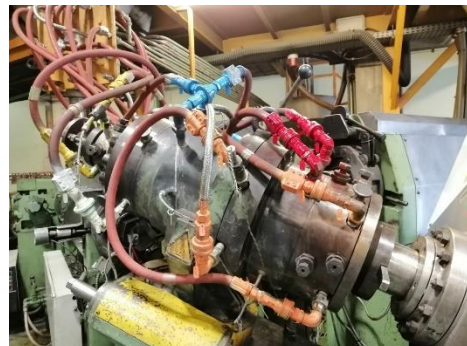
Figura 25 - Estado final das mangueiras de aquecimento da cabeça de extrusão
