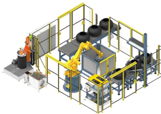
Figura 20 Estação robotizada de aplicação de silicone no interior de um pneu [2].
