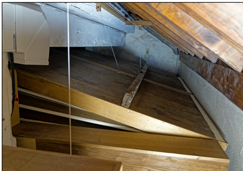
Figura 22 - Vista interior dos Foles e Sistema de Vento.
