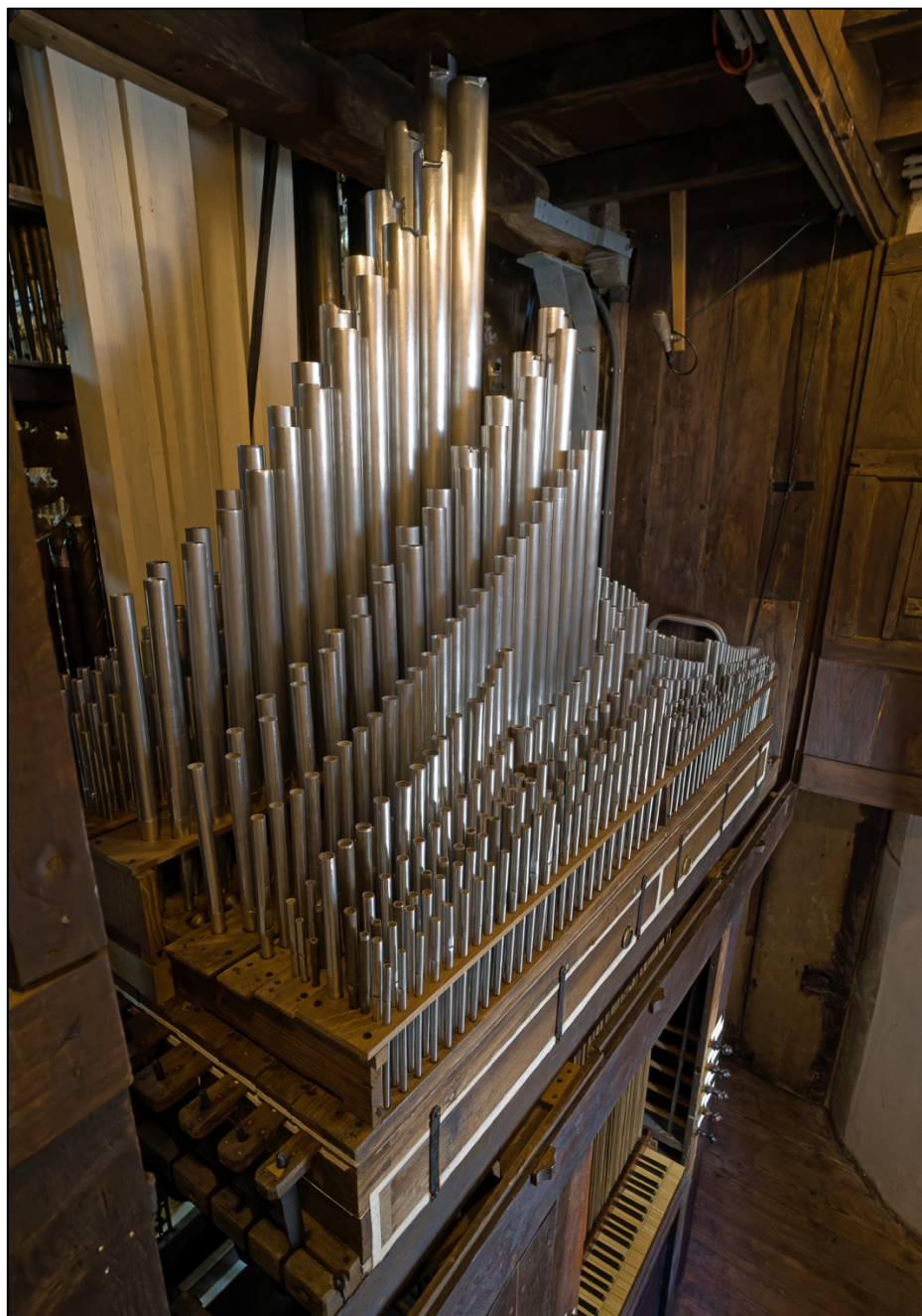
Figura 20 - Vista superior da Tubaria e Someiro.
