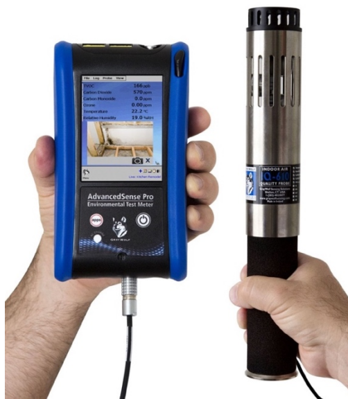
Figura 3-4 - Instrumento de medição da qualidade do ar interno (GrayWolf, 2022)
