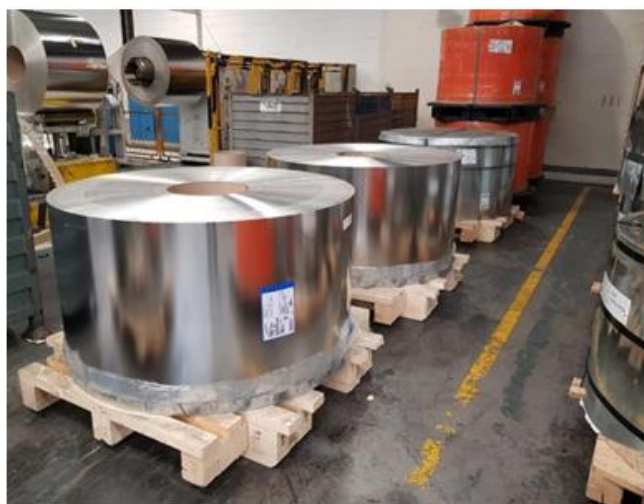
Figura 3.5 - Bobinas de folha de Flandres.
