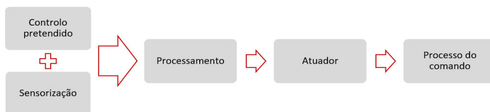
Figura 13 - Diagrama funcional de um sistema de controlo (adaptado de [16])
