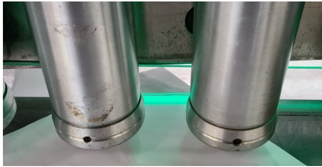
Figura 69 - Linha de corte destacada pela sombra do cabo de aço iluminado por LED verde
