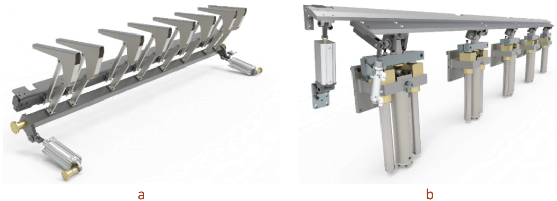
Figura 64 - Vista em perspetiva dos sistemas de mesa de apoio de chapas finas (a) e de anti torção (b)
