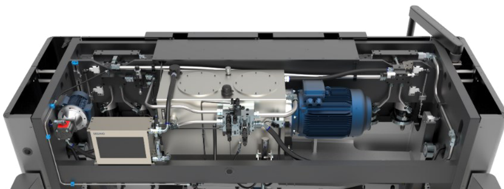
Figura 81 - Vista posterior com foco no circuito hidráulico da guilhotina desenvolvida
