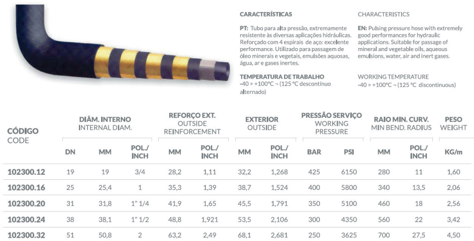
Figura 93 - Características do modelo de manga para mangueiras de alta pressão [72]
