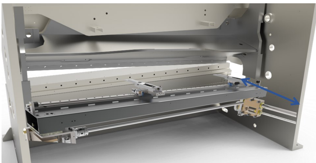
Figura 98 - Representação do esbarro de uma quinadora aplicado no modelo de guilhotina v2.0
