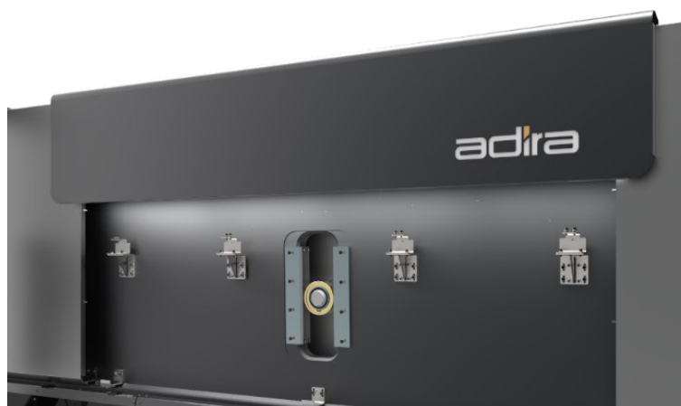
Figura 83 - Vista de pormenor, sem blindagem frontal, do guiamento central aplicado na máquina desenvolvida
