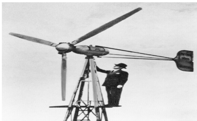
Figura 13 Turbina eólica de eixo horizontal desenvolvida por Marcellus Jacobs , rotor de diâmetro de cerca de 4 m e potência entre 1.8 a 3 kW, 1932 [58]
