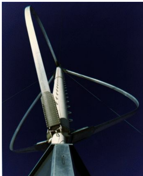
Figura 19 Chinook 2000 – pormenor das pás e da estrutura [70]
