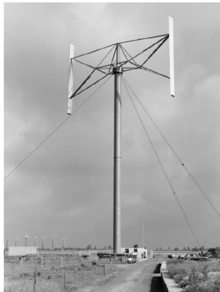
Figura 18 Turbina H-rotor , com um rotor de diâmetro 35 m e 300 kW de potência nominal [58]
