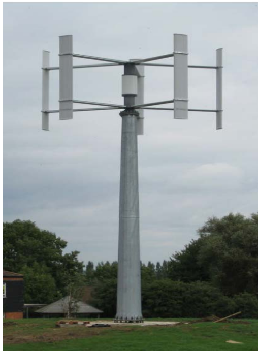
Figura 21 Turbina de eixo vertical do tipo H-rotor da Ropatec , potência 6 kW [26]
