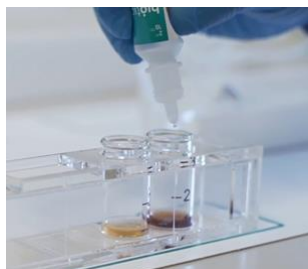
Figura 2.18 - Demonstração da adição do reagente de paragem.
