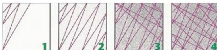
Figura 1.9 - Colheita com zaragatoa de biofilme. 1. Raspar a superfície diagonalmente de um lado ao outro. 2. Continuar a raspar até cobrir toda a superfície. 3. Raspar de novo na direção oposta. 4. Continuar a raspar até cobrir toda a superfície (Relacre, 2017).
