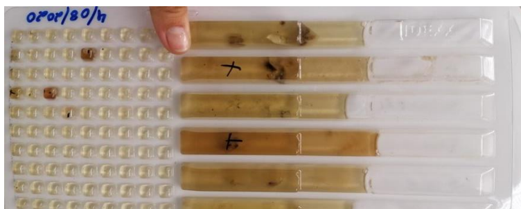
Figura 3.24 - Teste de Legiolert de um sistema de AVAC.
