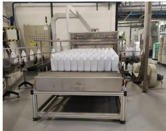
Figura 28 - Mesa de acumulação de garrafas da L340
