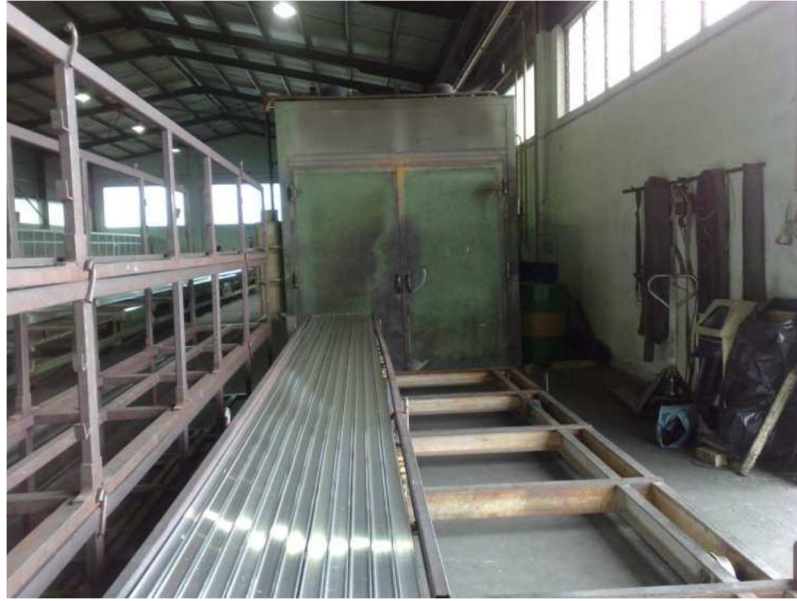
Figura 28: Estufa de envelhecimento da P1
