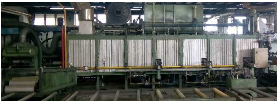
Figura 23: Rampa de introdução dos biletas no forno e forno de aquecimento
