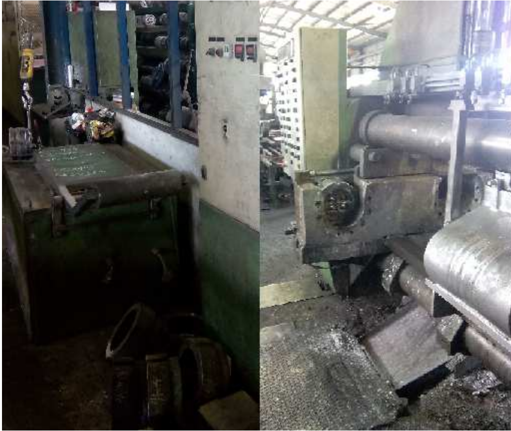
Figura 24:. Do lado esquerdo, forno de matrizes, do direito, local onde são introduzidas.
