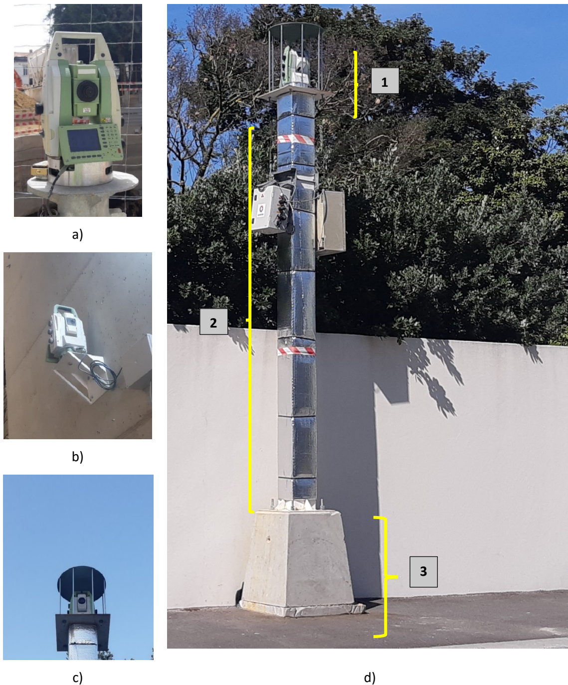
Figura 24 - Fotografias capturadas pela autora da disposição de uma estação total robotizada. a) localizada em obra no Hospital de Santo António. b) localizada no interior da trincheira coberta/túnel. c) em meio urbano da zona envolvente na Rua General Norton de Matos. d) Pormenor da estação total robotizada: 1- Cyclop, 2-pilar com isolamento metálico, 3- fundação em sapata.
