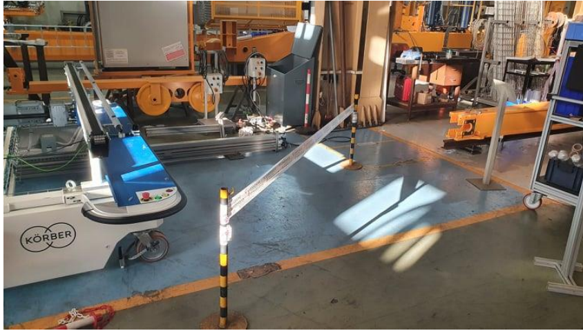
Figura 153 – Fita colocada numa posição diagonal à frente do RGV
