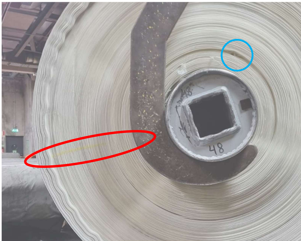
Figura 73 - Exemplo de rolo com defeito e J-Line deformada
