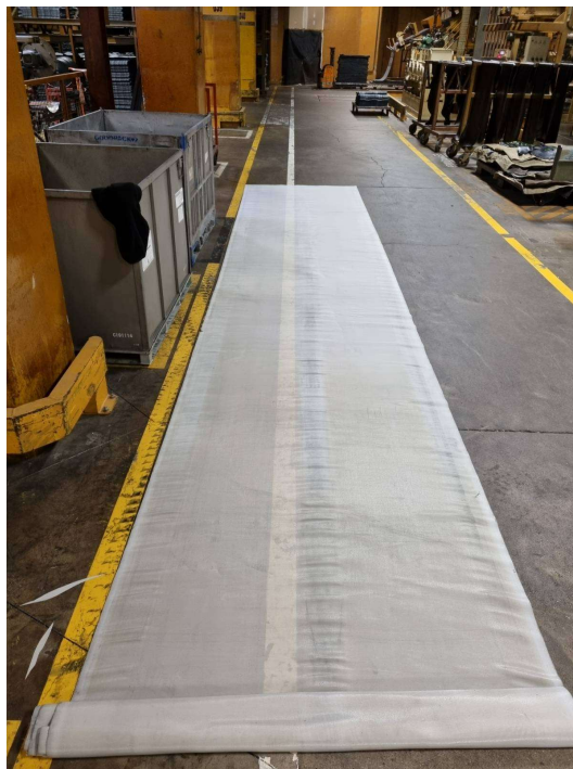
Figura 39 - Tecido de liner deformado devido a velcros
