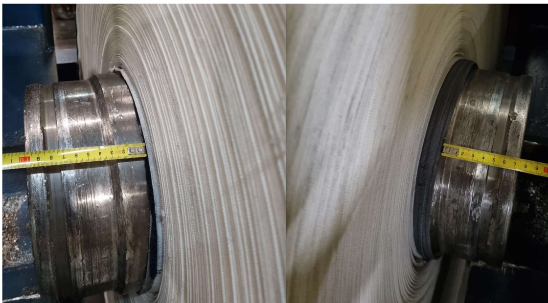
Figura 62 - Exemplo 2 de rolo descentrado do núcleo
