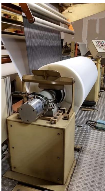
Figura 26 - Estação de enrolamento
