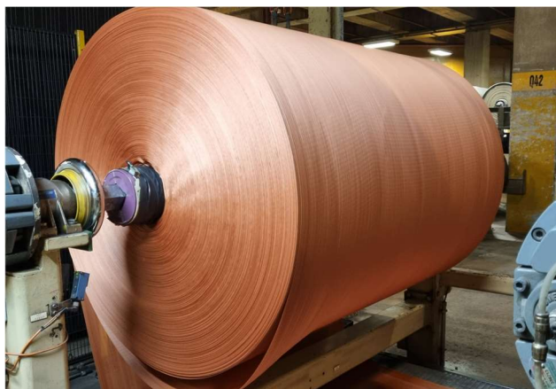
Figura 25 - Rolo de tecido em verde colocado numa estação de LetOff
