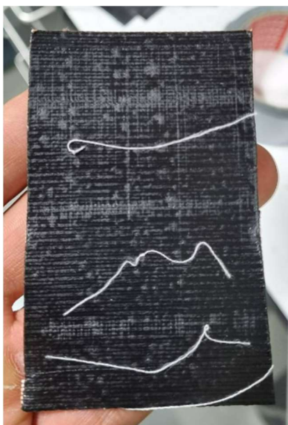
Figura 67 - Arrancamento de Bleeders
