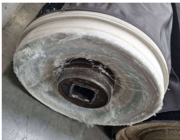
Figura 70 - Liner novo danificado por desalinhamento
