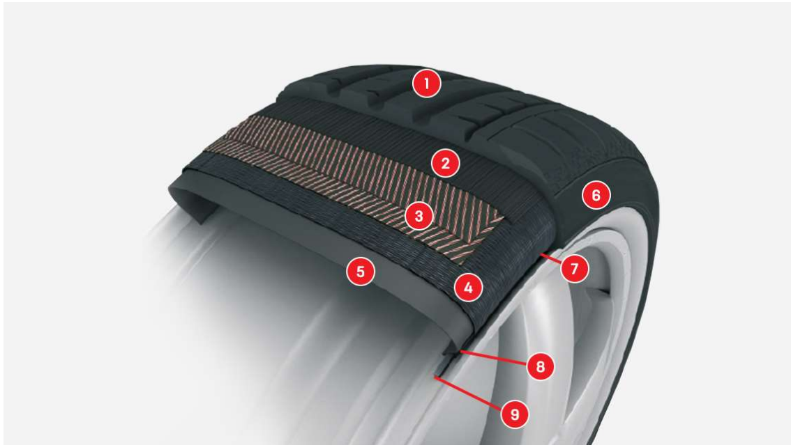
Figura 7 - Esquema de componentes do pneu (Uniroyal, 2021)
