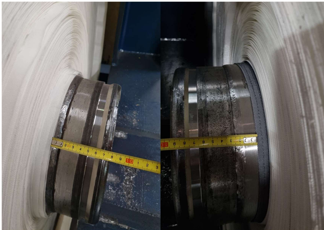
Figura 61 - Exemplo 1 de rolo descentrado do núcleo
