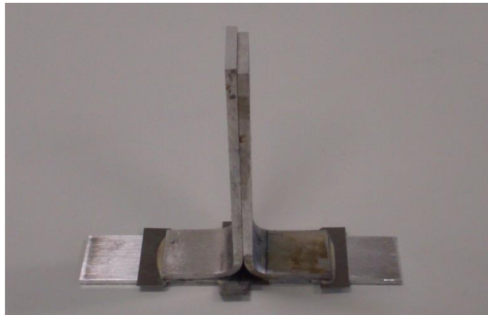
Figura 72 - Aspeto de junta pronta para teste.
