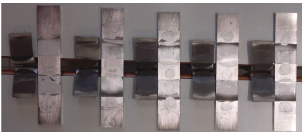
Figura 85 - Superfícies de rotura das juntas coladas com o adesivo Araldite® AV138 e t_{p2}=4 mm.
