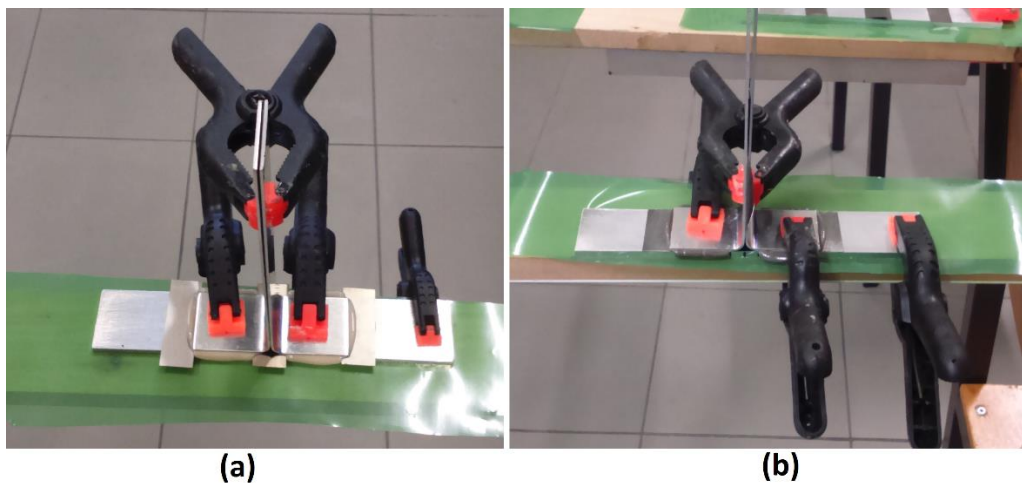
Figura 69 – Exemplo de juntas com aderentes em L com t_{p2}=1 mm: (a) com Araldite® 2015 e (b) com Araldite® AV138.
