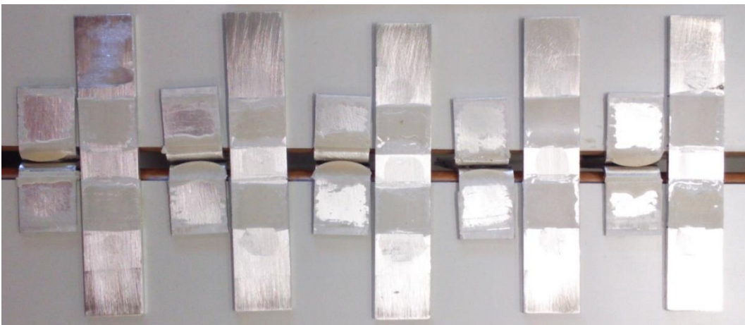
Figura 87 - Superfícies de rotura das juntas coladas com o adesivo Araldite® 2015 e t_{p2}=2 mm.
