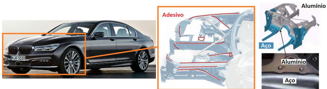
Figura 10 - Zonas de aplicação do adesivo no BMW série 7 [11].
