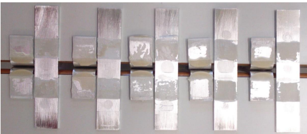
Figura 88 - Superfícies de rotura das juntas coladas com o adesivo Araldite® 2015 e t_{p2}=3 mm.
