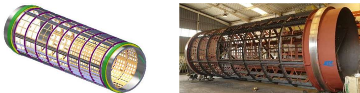
Fig. 1. Desenho técnico do crivo rotativo projetado (esquerda) e equipamento construído (direita).
