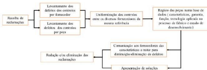
Figura 1 - Esquema do procedimento adotado para a recolha, tratamento e redução de defeitos “transversantes”
