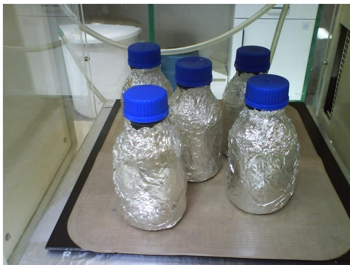
Figura 5. 13 Frascos rolhados de 500mL utilizados nos ensaios em descontínuos, revestidos a alumínio e colocados no agitador orbital
