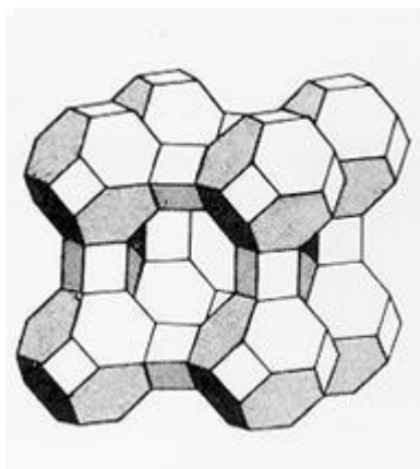
Figura 2. 3 Representação da rede cristalina da Clinoptilolite (Aguiar et al 2002)
