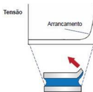
Figura 7 - Representação de uma solitação que causa esforço de arrancamento e as respectivas tensões ao longo da junta [9].
