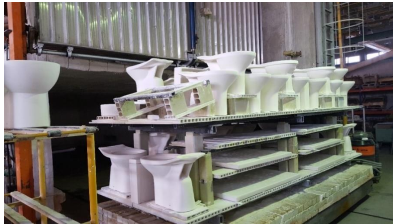
Figura 3.7 – Vista da entrada das peças no forno.
