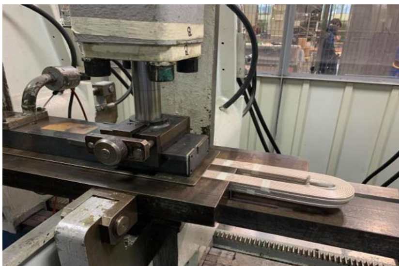
Figura 8 - Prensagem térmica da navete
