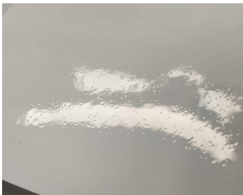
Figura 4. 26: Defeito de superfície, crateras
