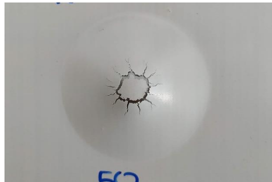
Figura G. 6: Resultado do ensaio de embutimento para o sistema epoxídico
