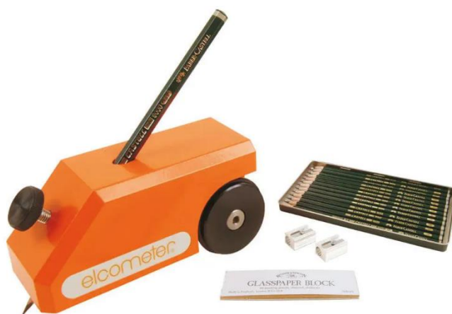
Figura 3. 17: KIT de instrumentos para o ensaio de dureza lápis, modelo H501 da Elcometer [38]
