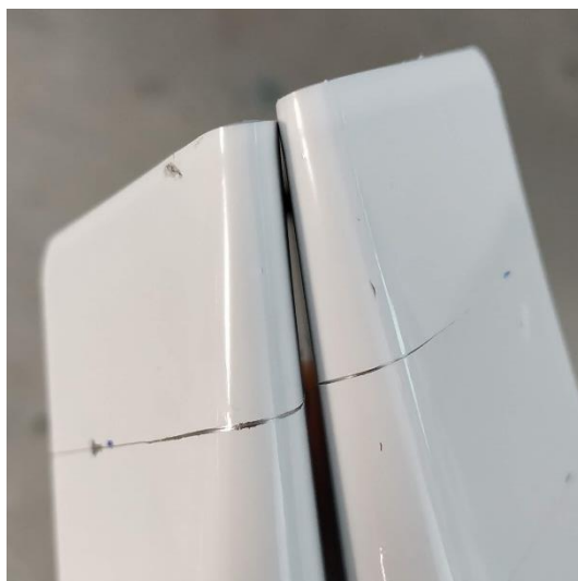
Figura G. 9: Resultado do ensaio de flexibilidade para o sistema de poliuretano
