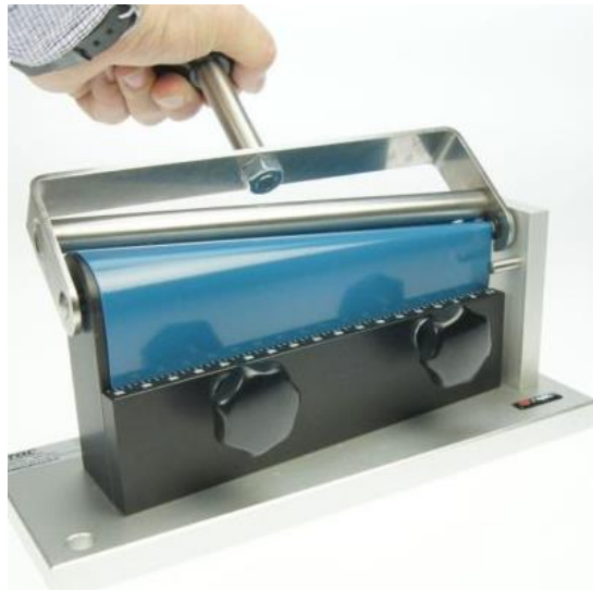
Figura 3. 14: Mandril cónico para testes de flexibilidade [34]
