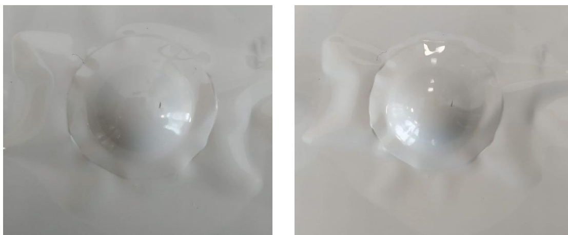
Figura G. 4: Resultado do ensaio de embutimento para o sistema poliaspártico
