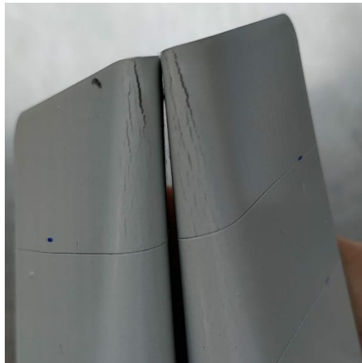
Figura G. 8: Resultado do ensaio de flexibilidade do sistema epoxídico
