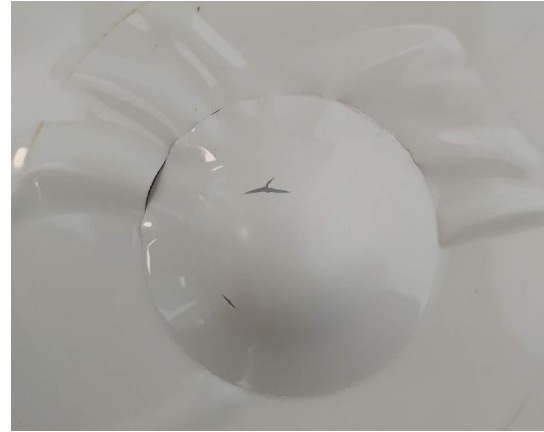
Figura G. 5: Resultado do ensaio de embutimento para o sistema de poliuretano
