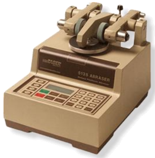
Figura 3. 16: Equipamento ensaios de resistência à abrasão, modelo 5135 Abraser da Taber Industries [37]
