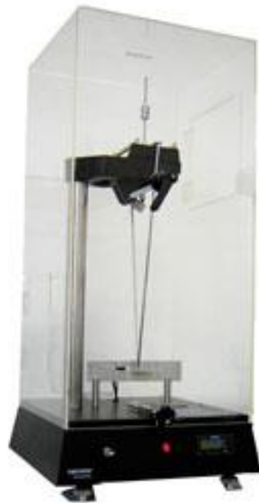
Figura 3. 4: Durómetro de pêndulo de König e Persoz, modelo 3034 M1 da Braive Instruments [17]
