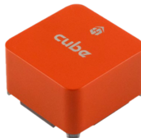
Figura 4.5: Cube Orange sistema para obtenção dos dados inerciais [9]
