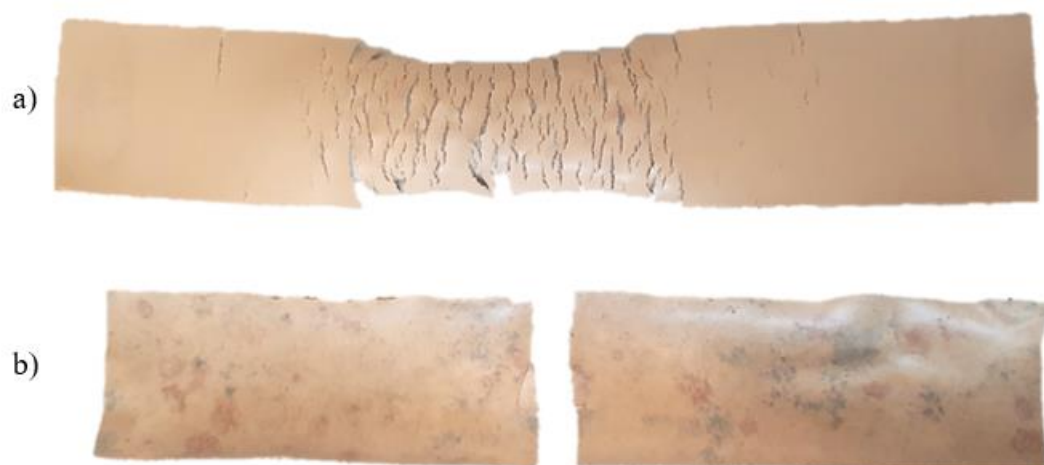
Figura 7.13 – a) Amostra do Produto 2 pré ensaio de biodegradação, após ensaio de resistência à tração; b) Amostra do Produto 2 pós ensaio de biodegradação, após ensaio de resistência à tração.
