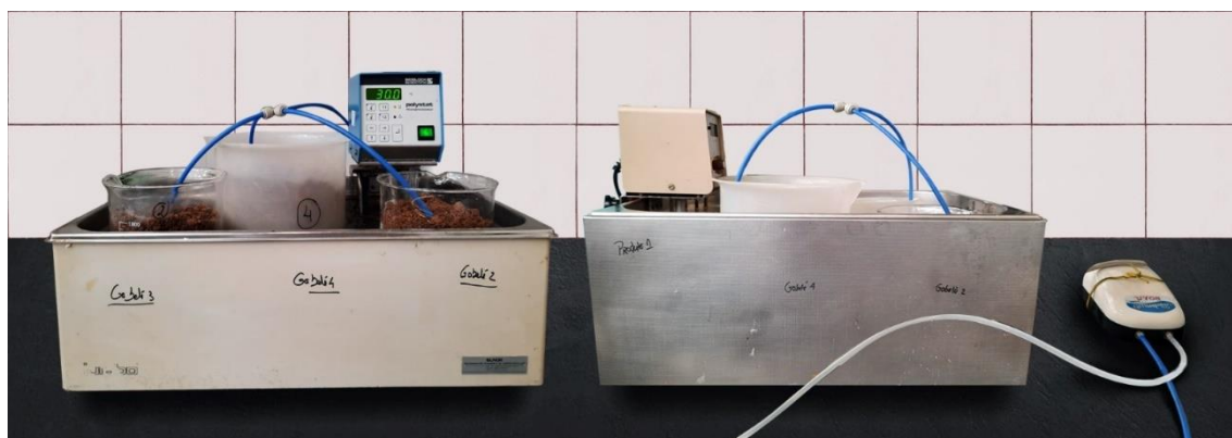
Figura 6.2 - Esquema da montagem completa do ensaio de biodegradabilidade, para os dois produtos a analisar.
