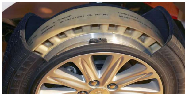
Figura 10 - Pneu com sistema PAX, da marca Michelin, onde está evidenciado o anel de apoio (a cor dourada) feito de poliuretano dentro do pneu [47].
