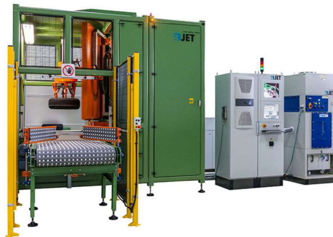
Figura 17 - Máquina de limpeza a laser do interior do pneu LCS, da marca 4Jet [63].
