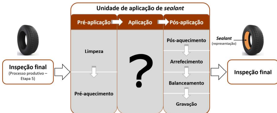
Figura 35 - Enquadramento da unidade de aplicação de sealant no processo produtivo do pneu.
