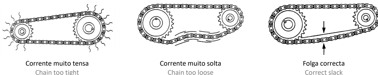
Fig. 5: Tensão adequada nas correntes | Adequate chain tension
