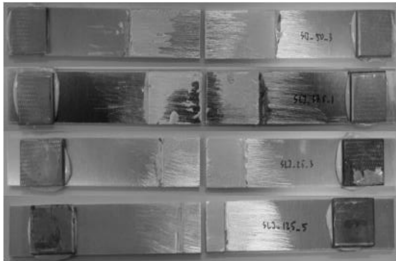
Figura 65 - Rotura coesiva em juntas com adesivo Sikaforce® 7752 e Lo de 12,5 mm, 25 mm, 37,5 mm e 50 mm [135].
