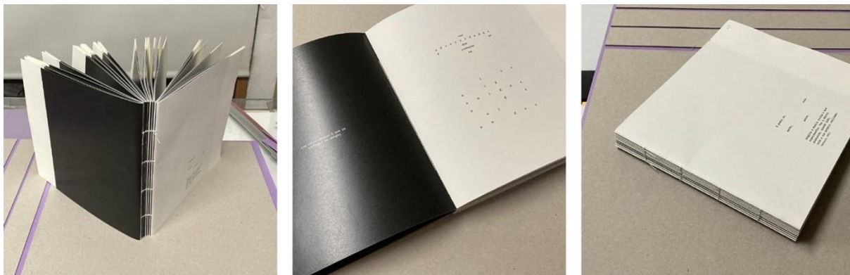
Figura 60: Processo final de encadernação antes da lombada ser colada, Autoria própria
