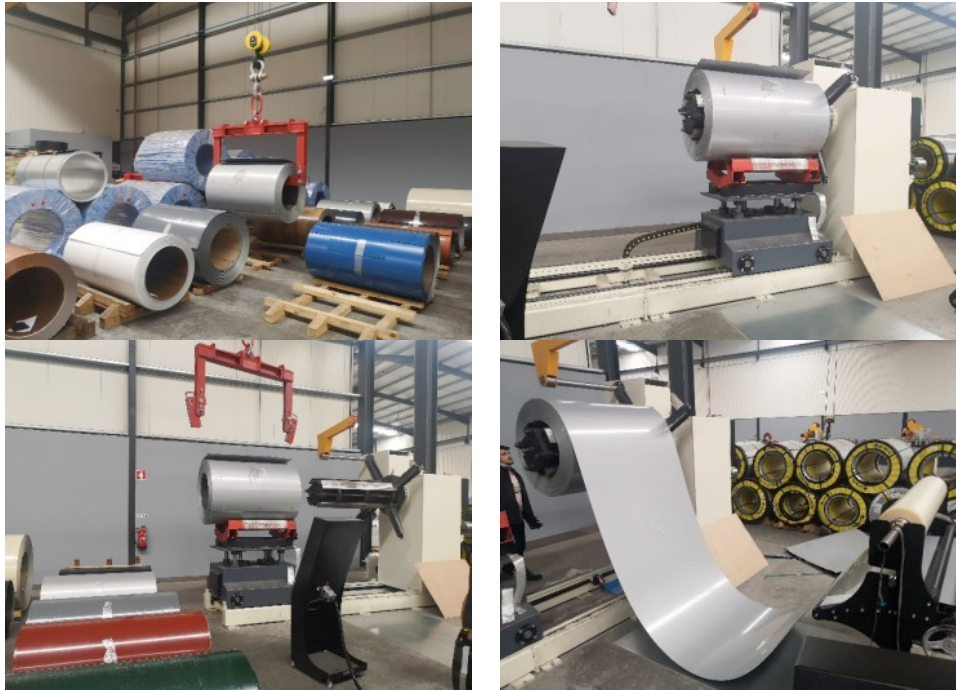
Figura 3 - Seleção e introdução da bobine na máquina
