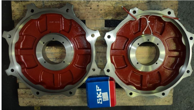
Figura 56 - Fotografia real da maquinagem das castanhas da TD
