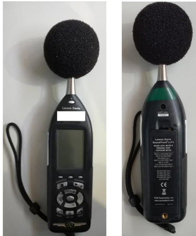
Figura 23 - Sonómetro Larson Davis SoundTrack LxT1
