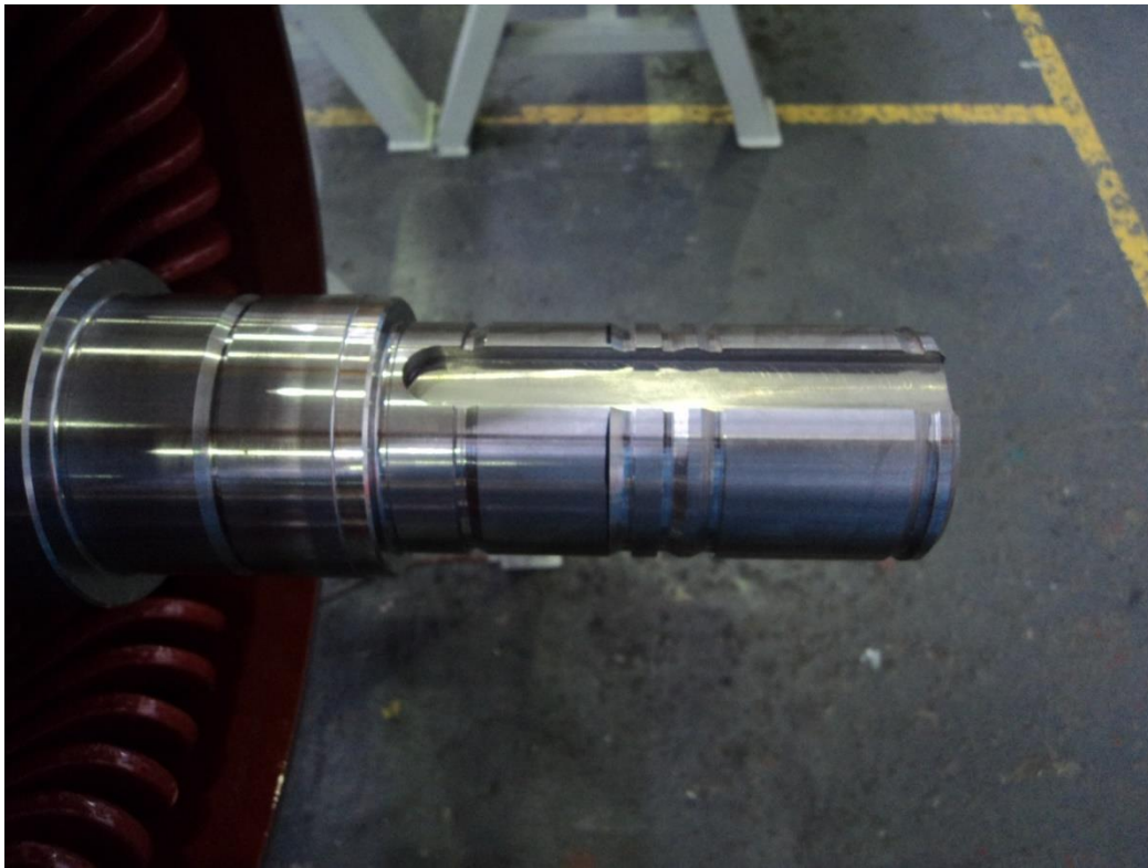
Figura 67 - Fotografia real do veio com as alterações realizadas
