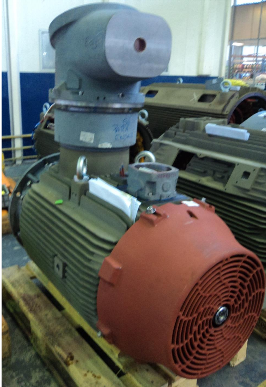
Figura 70 - Motor W22Xd 315 L 4P com as alterações efetuadas
