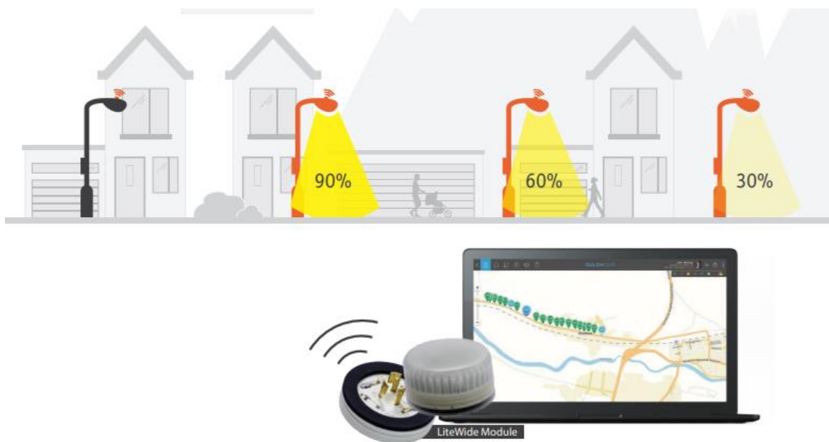
Figura 17 - Sistema de telegestão GSM (SUNDRAX Electronics, 2018).
