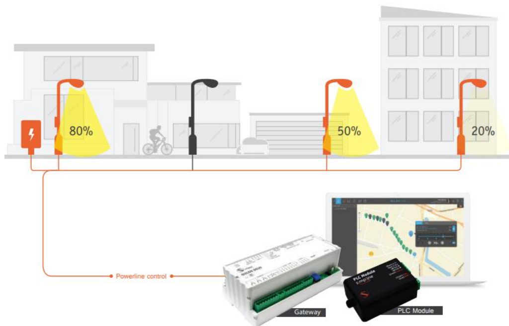
Figura 13 – Sistema de telegestão PLC (SUNDRAX Electronics, 2018).
