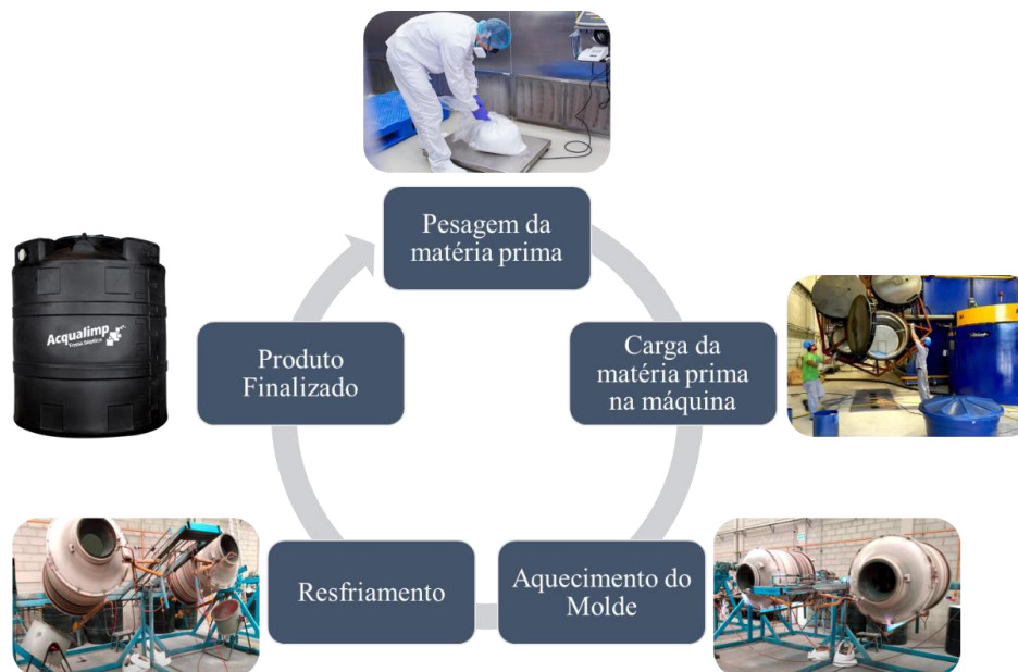
Representação do Processo de Rotomoldagem
