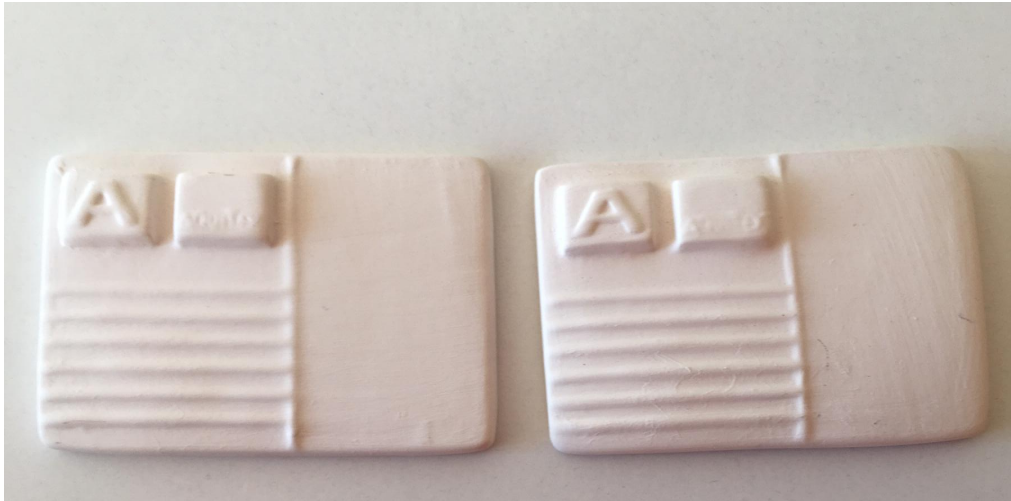
Figura 4. 9 - Vista frontal das peças cozidas após aplicação do silicato de sódio: (à esquerda) silicato de sódio comercial; (à direita) silicato de sódio experimental.
