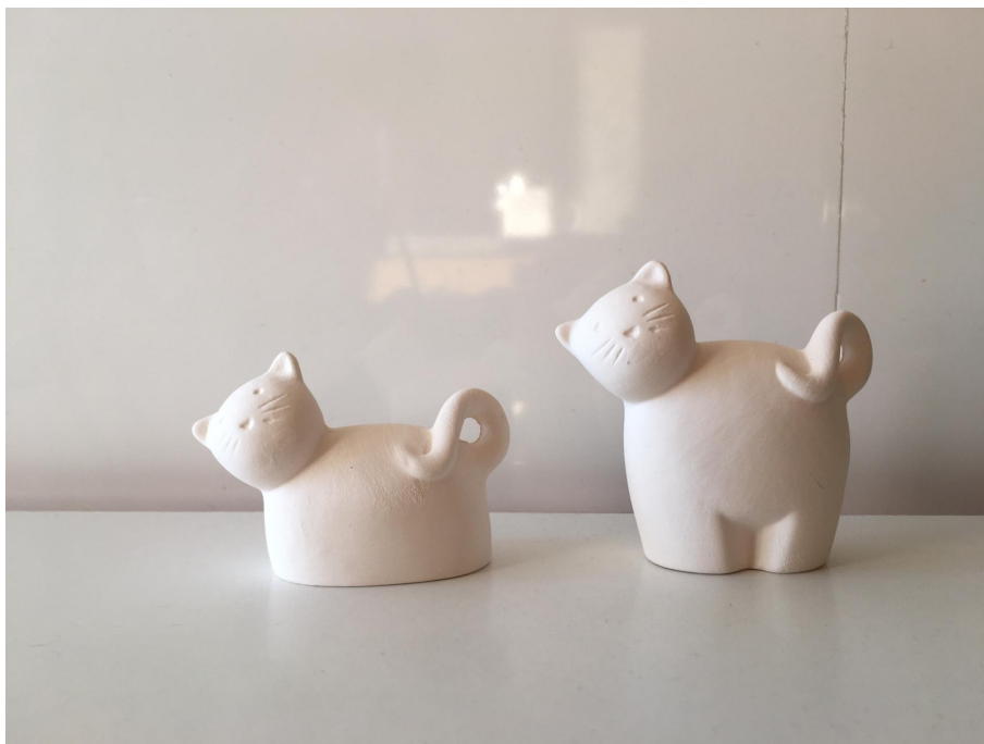
Figura 4. 11 - Peças cozidas após o enchimento por barbotina: (à esquerda) peça com o silicato de sódio experimental; (à direita) peça com o silicato de sódio comercial.
