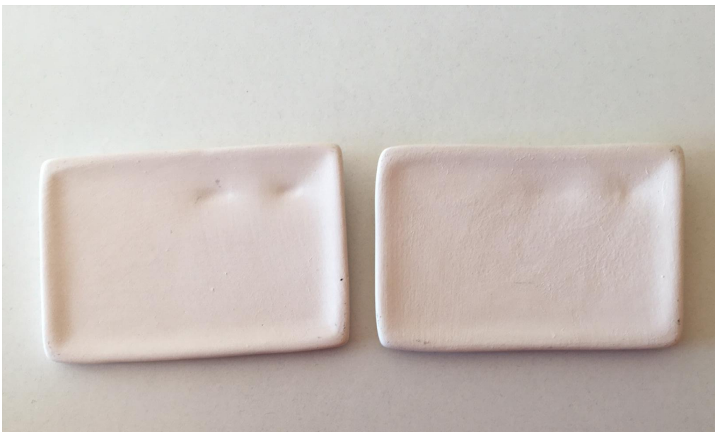
Figura 4. 10 - Vista traseira das peças cozidas após a aplicação do silicato de sódio: (à esquerda) silicato de sódio comercial; (à direita) silicato de sódio experimental.
