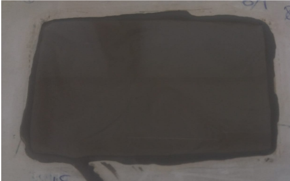
Figura 3.1 – Preenchimento da placa de gesso com a pasta que contém o silicato de sódio comercial
