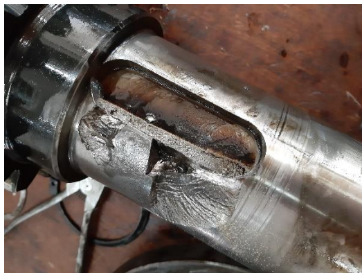
Figura 40 - Veio de carreto de 2ª redução fissurado
