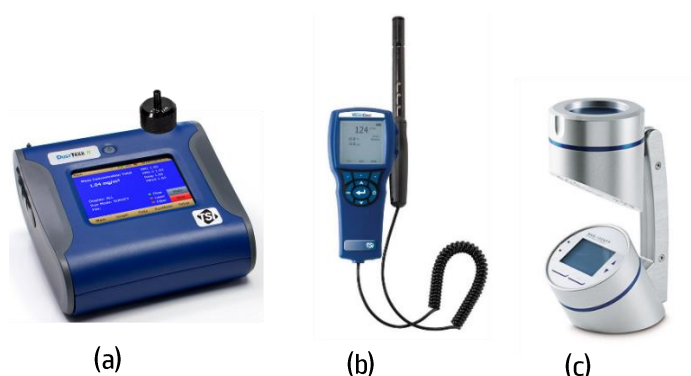
Figura 6 – Equipamentos de Medição da QAI (a) DustTrack II ; (b) Monitor Multifunções; (c) MAS 100
