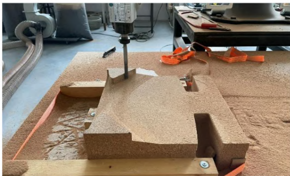
Figura C8 - Fresagem do assento. Elaboração própria (2025).
