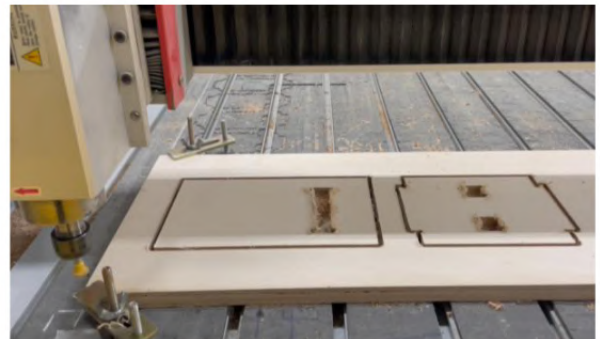
Figura 50 – Segundo ensaio seccional. Fresagem do encaixe T-slot. Elaboração própria (2025).
