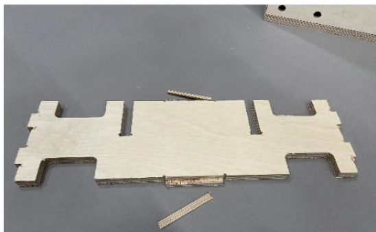
Figura A21 – Teste de encaixe T-slot. A profundidade do rebaixo revelou-se excessiva, fragilizando a união. Elaboração própria (2025).
