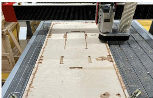
Módulo de Teste. Fresagem em CNC. Elaboração própria (2025).
