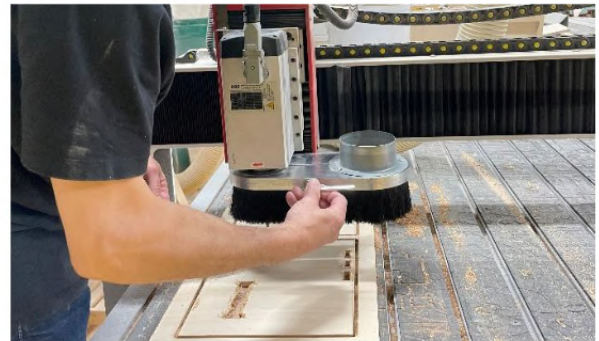
Figura 54 – Terceiro ensaio seccional. Troca da fresa. Elaboração própria (2025).
