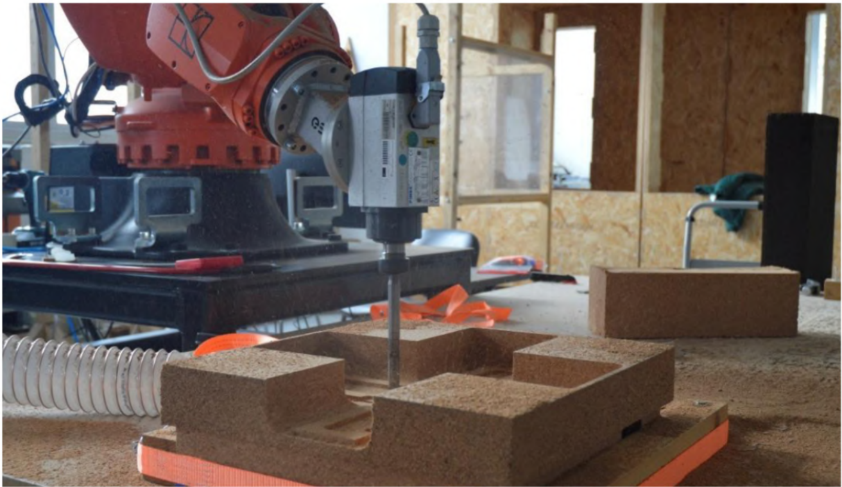
Figura 1 – Projeto Corkuka: cadeira em fase de produção por CNC montada em braço robótico. Elaboração própria (2025).
