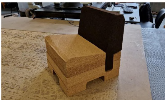
Figura C10- Cadeira Corkuka com erros de alinhamento a corrigir manualmente. Elaboração própria (2025).
