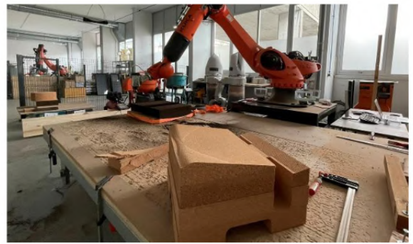
Figura C9 - Fresagem do encosto. Elaboração própria (2025).
