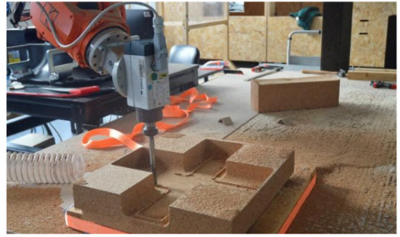
Figura C7 - Fresagem da face inferior da base. Elaboração própria (2025).
