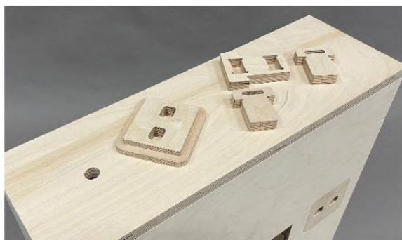
Figura 34 - Tampa e cunhas de travamento para ligação entre módulos. Elaboração própria (2025)
