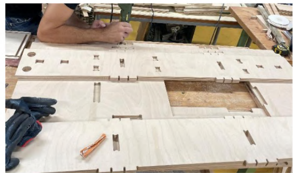
Módulo de Teste. Retificação manual das peças. Elaboração própria (2025).
