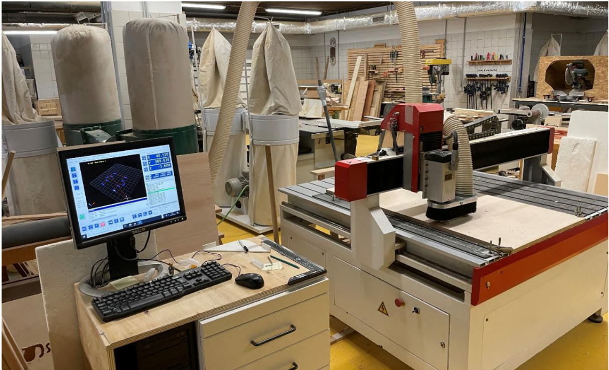
Figura A11 – Oficina de Design Industrial da ESMAD. Máquina CNC Pronum utilizada no processo de fabrico. Elaboração própria (2025).
