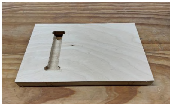
Figura A20 – Teste de encaixe T-slot. A profundidade do rebaixo revelou-se excessiva, trespassando a placa. Elaboração própria (2025).
