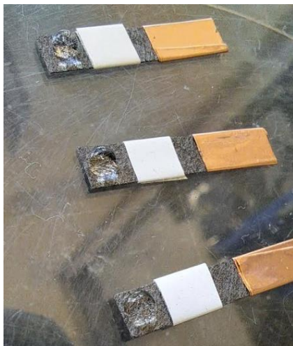
Figura 2.3 - Biomodificação eléctrodo de papel de fibra de carbono com anticorpo anti-trimetoprim policlonal.
