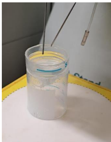
Figura 3.3 - Miniaturização da célula eletroquímica através de um tubo Falcon®.
