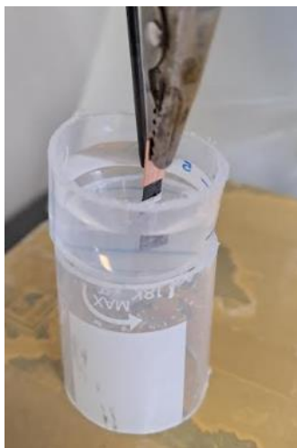
Figura 2.2 - Miniaturização da célula eletroquímica usando um Falcon®.
