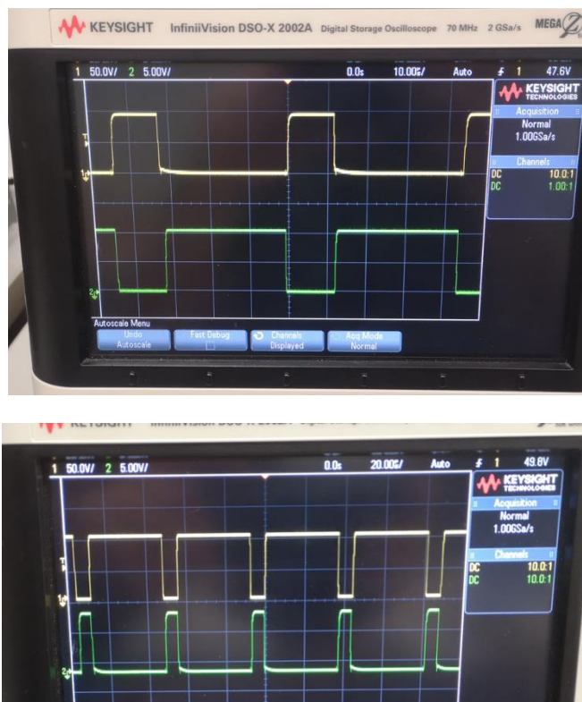
Figura 39 – Sinais PWM de acionamento dos MOSFET do conversor
