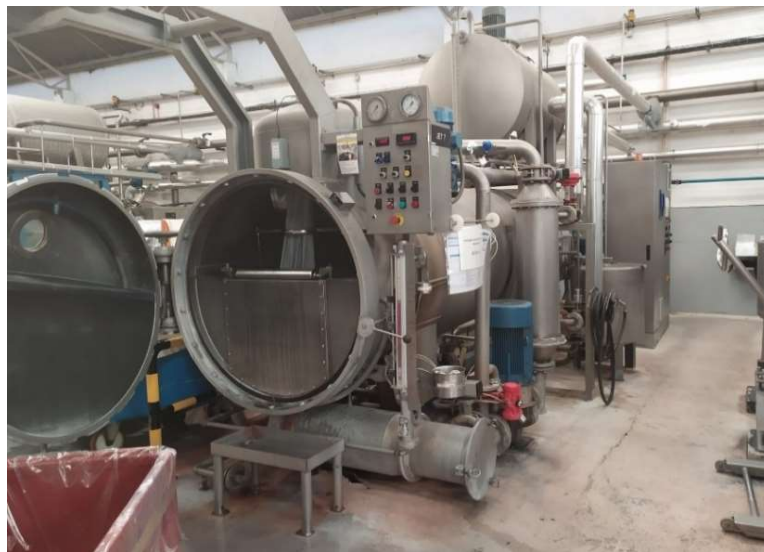
Figura 2.6. Equipamento utilizado para o tingimento do poliéster na empresa.
