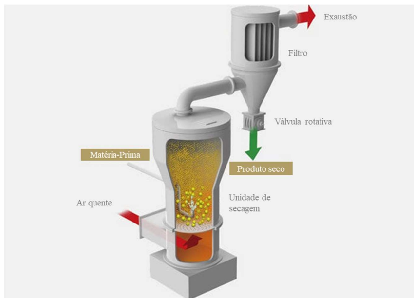
Figura 3.3. Secador de leito fluidizado (Adaptado de [18]).
