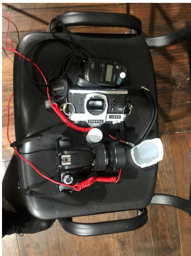
Figura 80 – Fotómetro Sekonic L-308X Flashmate, câmara analógica suplente – Canon FTB QL; Câmera digital - Canon 4000D e cabo de sincronização para o flash.
