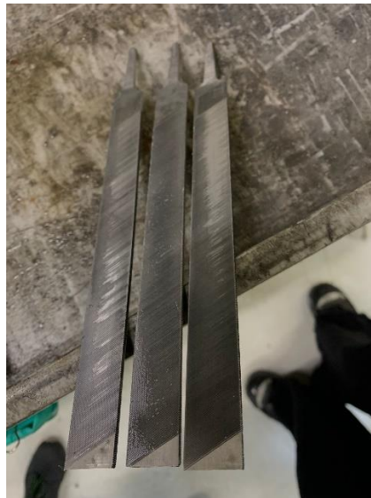
Figura 18- Limas com defeitos
