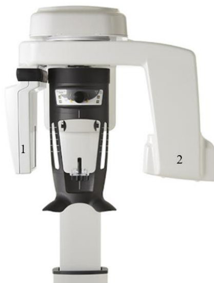
Figura 3.2 - Ortopantomógrafo em que 1 representa o detetor de imagem e 2 a ampola de raios X. Adaptado de [37].
