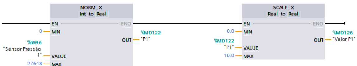
Figura 25 Funções NORM_X e SCALE_X
