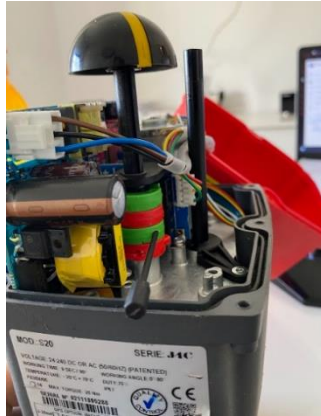
Figura 41 Afinação da Válvula de Três Vias
