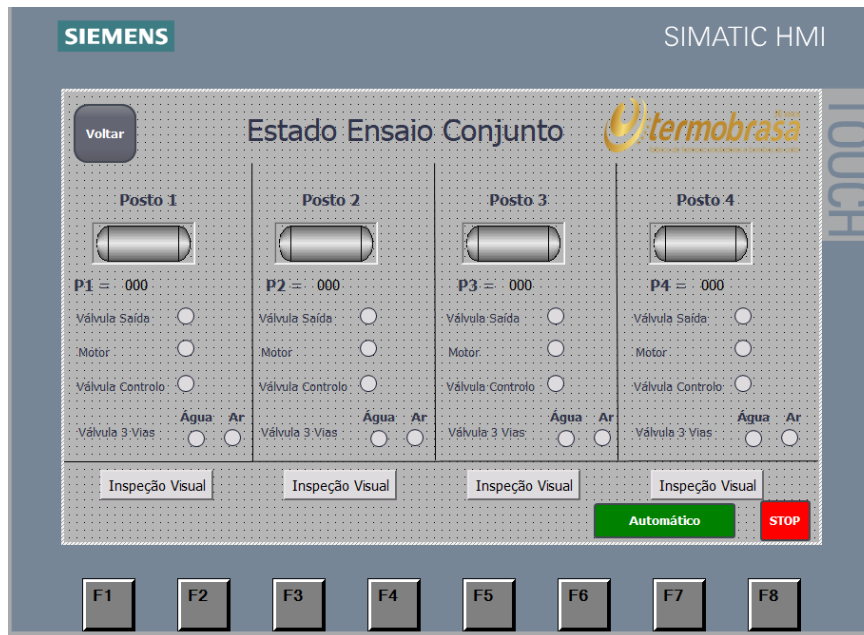
Figura 34 Página Ensaio com quatro postos em simultâneo
