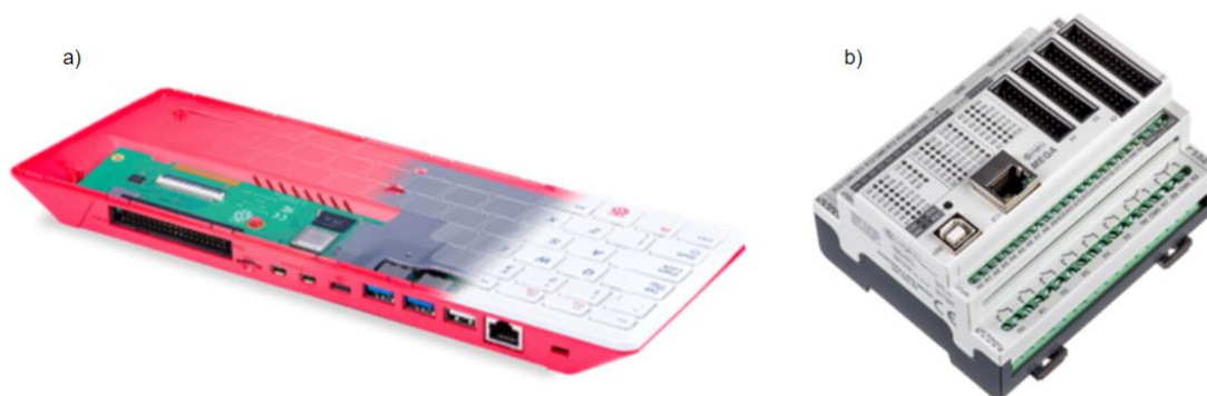
Figura 41 - Componentes físicos do Sistema de Informação e Controlo: a) Raspberry Pi 400, b) Controllino.
