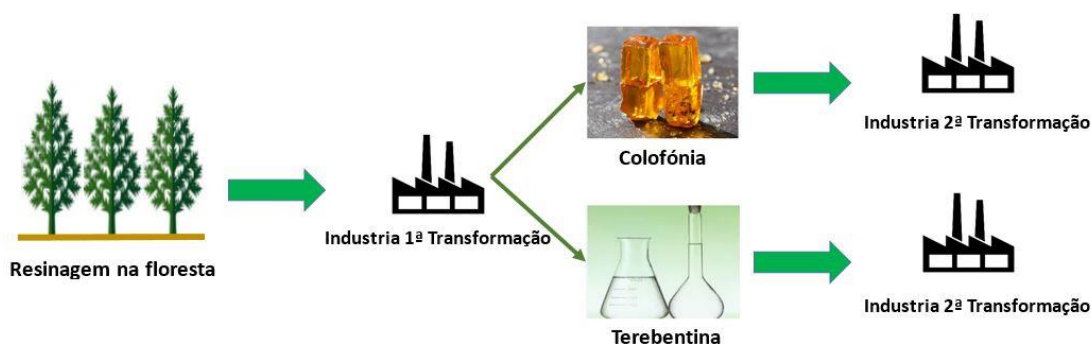
Figura 2 - Esquema representativo do processo de tratamento da resina (Resipinus, 2022).
