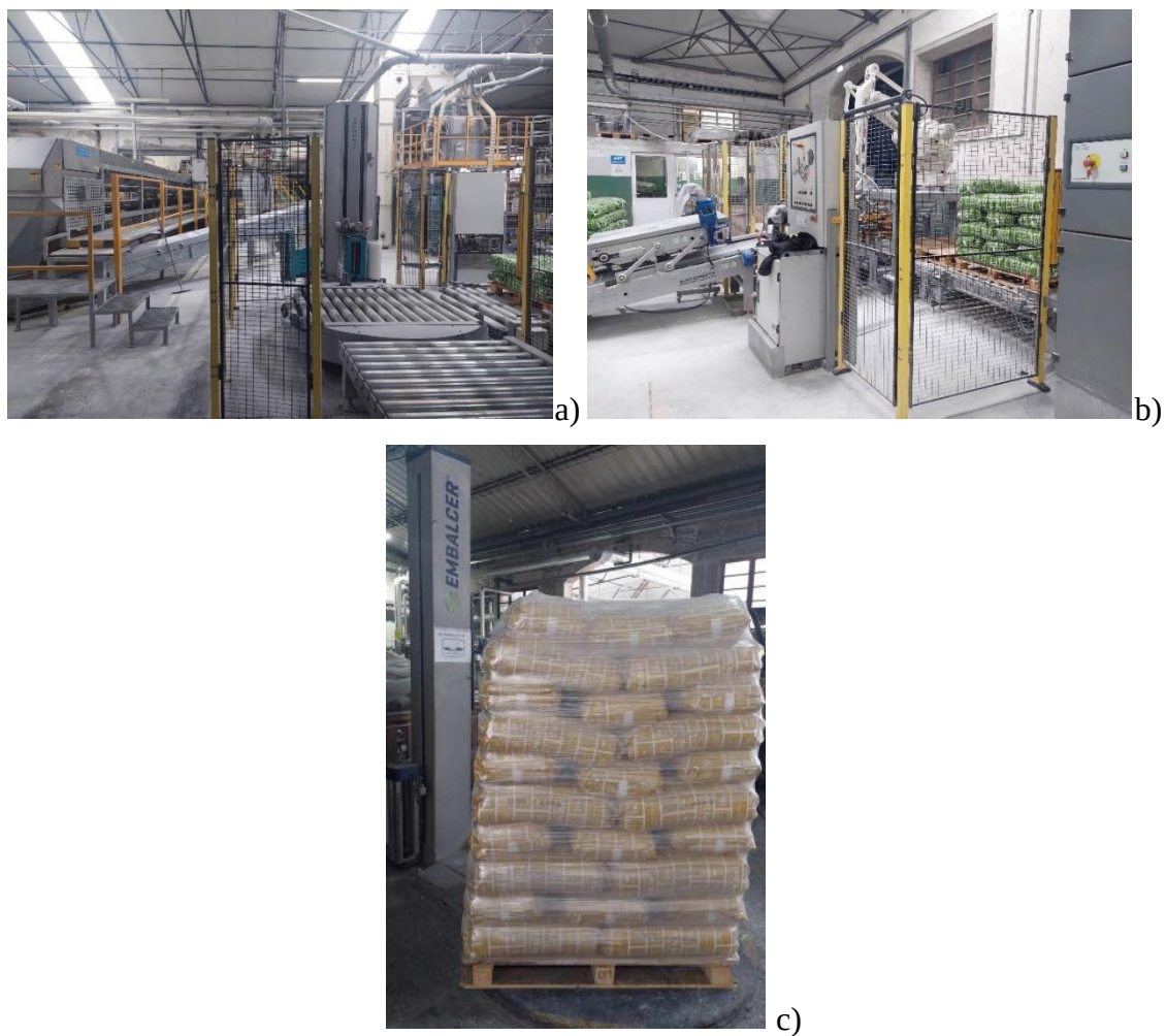
Figura 5 - a) Tela de descarga refrigerada, b) Produto ensacado e colocado em paletes e c) Filmagem de paletes.
