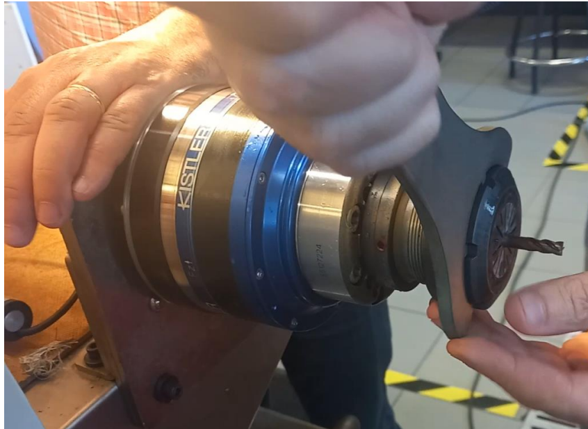
Figura 17 - Exemplo processo troca de uma ferramenta
