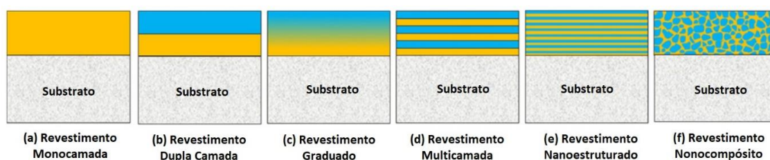
Figura 7 - Arquiteturas típicas de revestimento [33]
