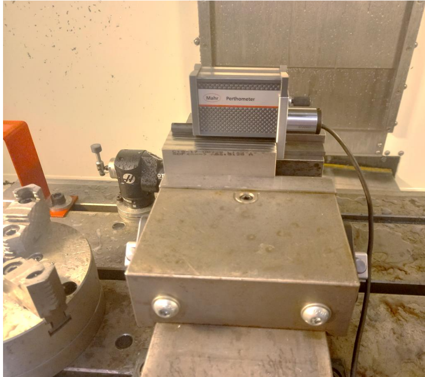
Figura 18 - Medição da rugosidade superficial com rugosímetro
