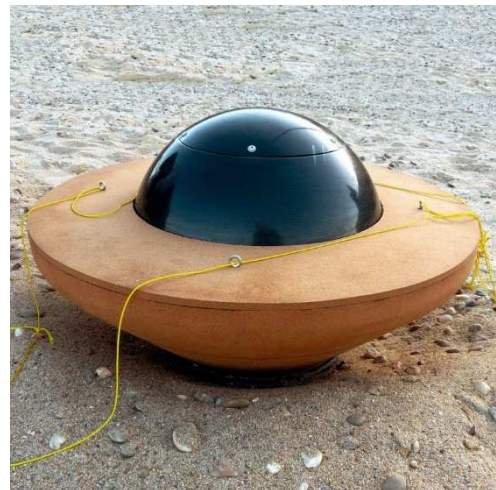
Figura 3 - Cortiça aplicada numa cápsula de reentrada na atmosfera, em 2019 Adaptado de [6]
