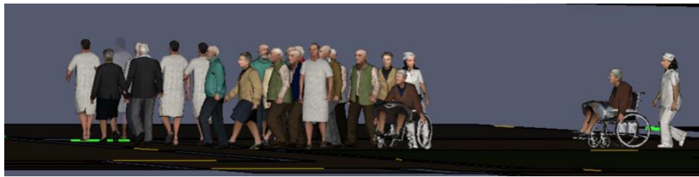
Figura 93 - "Bottleneck" no acesso à saída de emergência pelo refeitório (Cenário 9 - Todas as portas abertas)
