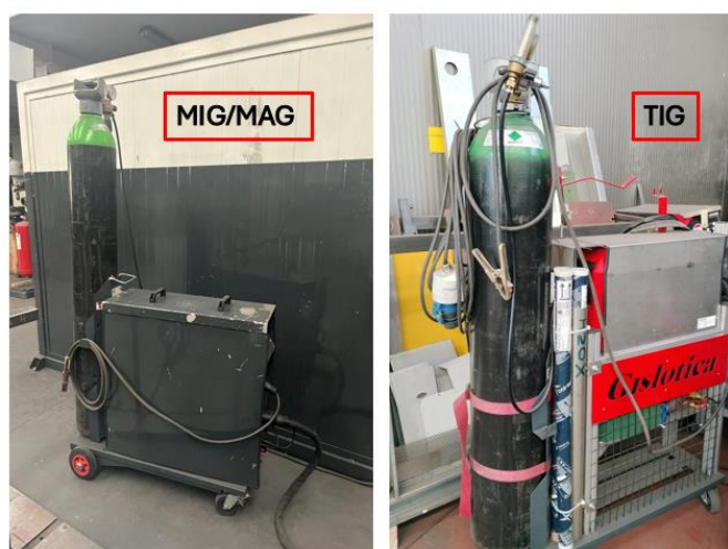
Figura 16 - Máquinas de Soldadura
