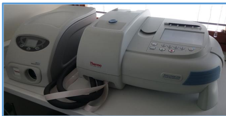
Figura 2.13 - Espectrofotômetro UV-Vis da marca Thermo Scientific, modelo Evolution 220.
