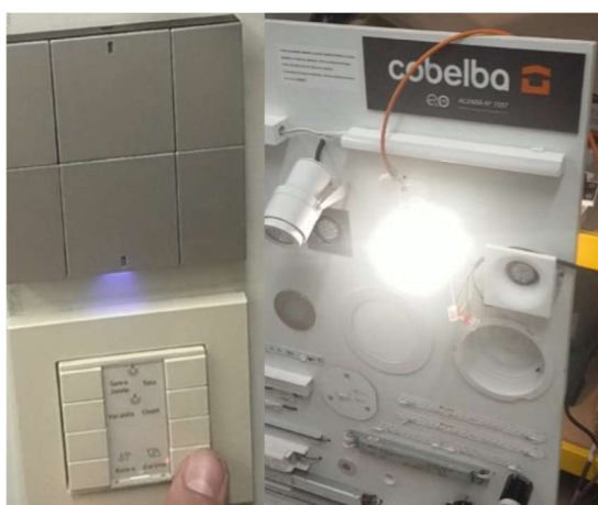
Figura 27 – Comando de foco de LED do painel de iluminação
