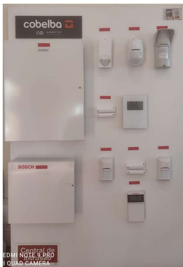
Figura 25 - Painel de Sistema Automático de Deteção de Intrusão
